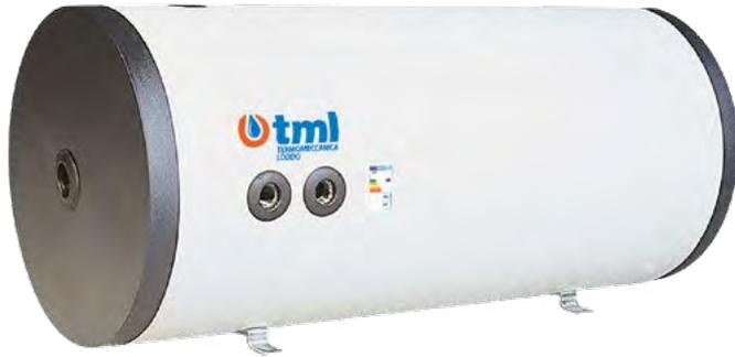
Bollitore per la produzione e lo stoccaggio di Acqua Calda Sanitaria. Scambiatore di calore realizzato mediante una doppia parete periferica. Installabile con sistema di fissaggio a muro, sia in posizione orizzontale che verticale.
