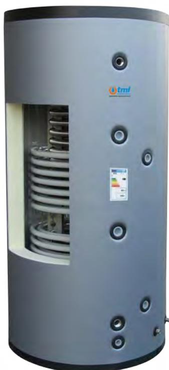
Termoaccumulo per lo stoccaggio di acqua da riscaldamento prodotta da sorgenti di calore continue o discontinue. Il volano inerziale ha al suo interno uno scambiatore di calore con elevata superficie di scambio capace di trasferire la potenza generata da una caldaia a biomassa. Produzione istantanea di Acqua Calda Sanitaria per mezzo di uno scambiatore di calore in acciaio Inox AISI 316L corrugato ad alta efficienza.
