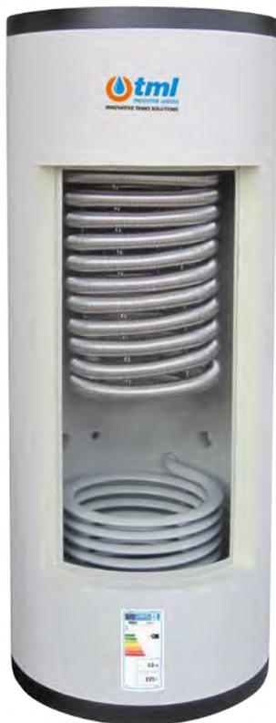
Termoaccumulo per lo stoccaggio di acqua da riscaldamento prodotta da sorgenti di calore continue o discontinue; produzione istantanea di Acqua Calda Sanitaria per mezzo di uno scambiatore di calore in acciaio Inox AISI 316L corrugato ad alta efficienza. Piccole taglie per installazioni domestiche.
