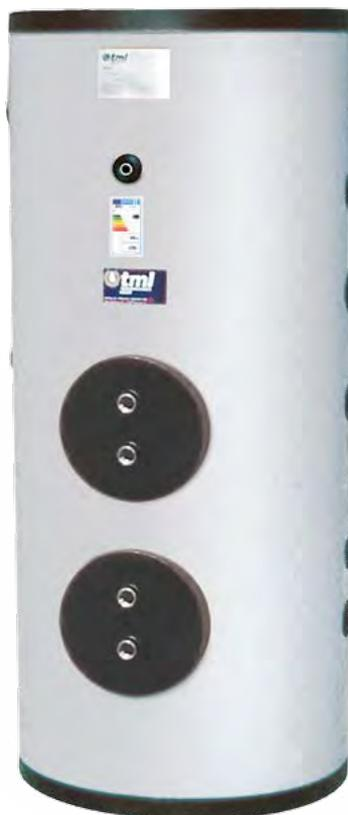
Bollitore per la produzione e lo stoccaggio di Acqua Calda Sanitaria. Il bollitore è realizzato in acciaio al carbonio protetto mediante trattamento interno vetroporcellanato/Keramtech. È dotato di due scambiatori di calore estraibili a fascio tubiero in acciaio Inox o rame. Lo scambiatore inferiore è curvato verso il basso per prevenire la proliferazione batterica nella zona più fredda del bollitore.
