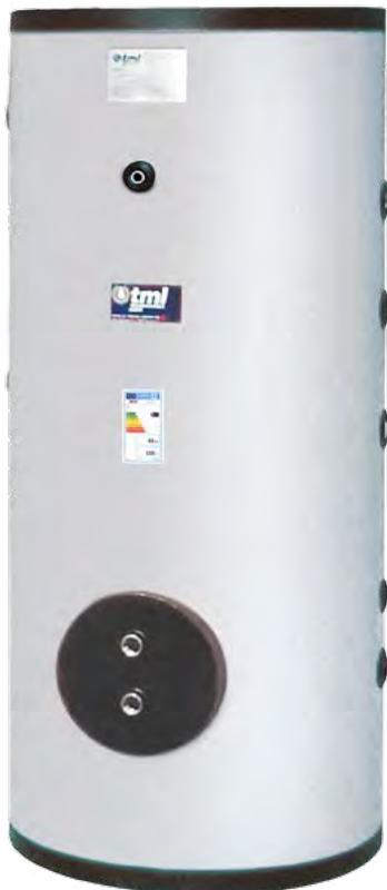
Bollitore per la produzione e lo stoccaggio di Acqua Calda Sanitaria. Il bollitore è realizzato in acciaio al carbonio protetto internamente mediante trattamento Blueline, è dotato di uno scambiatore di calore a fascio tubiero estraibile in rame o acciaio Inox.
