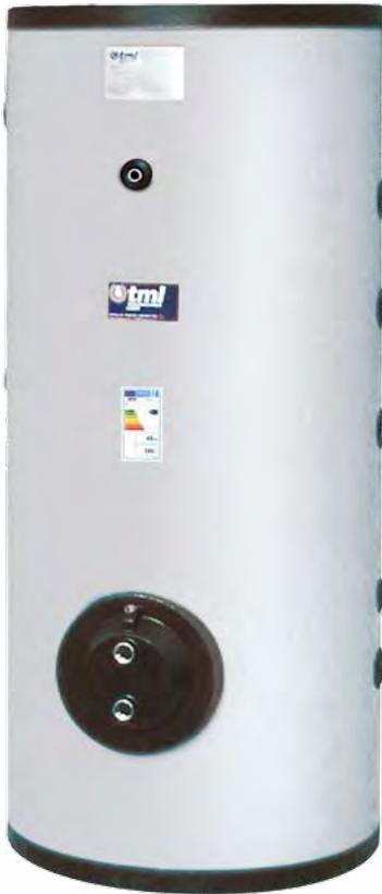
Bollitore per la produzione e lo stoccaggio di Acqua Calda Sanitaria. Il bollitore, realizzato in acciaio Inox AISI 316L, è dotato di scambiatore di calore a fascio tubiero in acciaio Inox AISI 316L idoneo ad essere alimentato con vapore. Lo scambiatore di calore è corredato di Dichiarazione di Conformità PED (ai sensi dell'Allegato VII della Direttiva Europea 97/23/CE).
