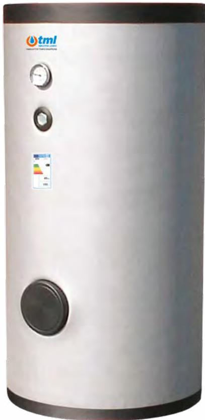
Bollitore in acciaio Inox AISI 316L per la produzione e lo stoccaggio di Acqua Calda Sanitaria dotato di uno o due scambiatori di calore a serpentino fisso interno ad alta superficie di scambio; possono essere alimentati da pompa di calore e impianto solare.
