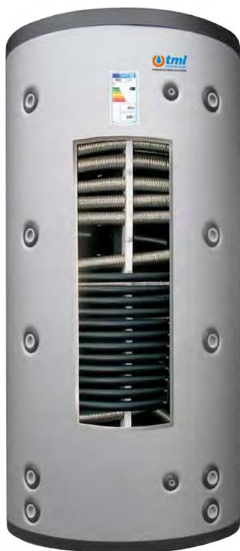
Termoaccumulo per lo stoccaggio di acqua da riscaldamento prodotta da sorgenti di calore continue o discontinue; produzione istantanea di Acqua Calda Sanitaria per mezzo di uno scambiatore di calore in acciaio Inox AISI 316L corrugato ad alta efficienza.
