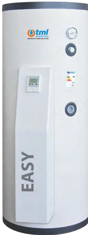
Bollitore per la produzione e lo stoccaggio di Acqua Calda Sanitaria dotato di doppio scambiatore di calore a serpentino fisso interno. Viene fornito completo di modulo solare e centralina di controllo già predisposta per il collegamento diretto al pannello solare.
