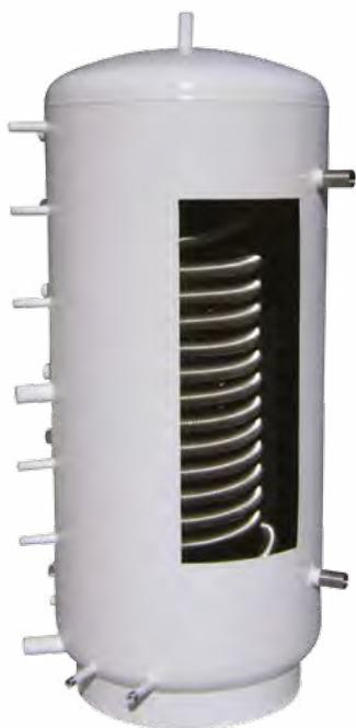
Termoaccumulo per lo stoccaggio di acqua da riscaldamento prodotta da sorgenti di calore continue o discontinue; produzione istantanea di Acqua Calda Sanitaria per mezzo di uno scambiatore di calore in acciaio Inox AISI 316L corrugato ad alta efficienza. Innovativo sistema di distribuzione dei fluidi primari che aumenta le performance nelle condizioni di lavoro più critiche.
