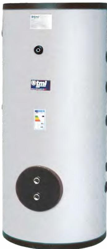
Bollitore per la produzione e lo stoccaggio di Acqua Calda Sanitaria. Il bollitore è realizzato in acciaio al carbonio protetto mediante trattamento interno vetroporcellanato/Keramtech. È dotato di scambiatore di calore estraibile in rame alettato stagnato.
