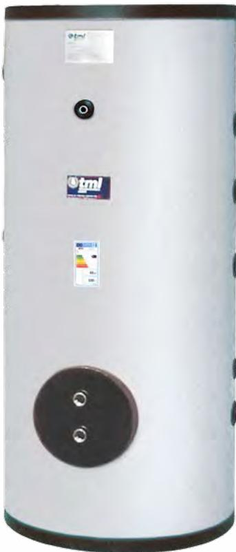
Bollitore per la produzione e lo stoccaggio di Acqua Calda Sanitaria. Il bollitore è realizzato in acciaio al carbonio protetto mediante trattamento interno Keramtech. È dotato di scambiatore di calore estraibile a fascio tubiero in rame o acciaio Inox.
