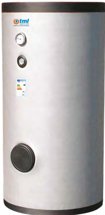
Bollitore in acciaio al carbonio vetroporcellanato per la produzione e lo stoccaggio di Acqua Calda Sanitaria dotato di uno o due scambiatori di calore a serpentino fisso interno ad alta superficie di scambio; possono essere alimentati da pompa di calore e impianto solare.
