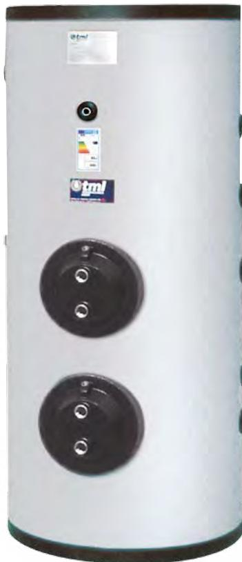
Bollitore in acciaio Inox AISI 316L per la produzione e lo stoccaggio di Acqua Calda Sanitaria. Il bollitore è dotato di due scambiatori di calore estraibili a fascio tubiero in acciaio Inox AISI 316L. Lo scambiatore inferiore è curvato verso il basso per prevenire la proliferazione batterica nella zona più fredda del bollitore.
