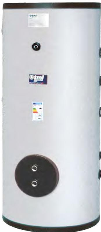
Bollitore per la produzione e lo stoccaggio di Acqua Calda Sanitaria. Il bollitore è realizzato in acciaio al carbonio protetto mediante trattamento interno vetroporcellanato/Keramtech. È dotato di scambiatore di calore estraibile a fascio tubiero in rame o acciaio Inox.
