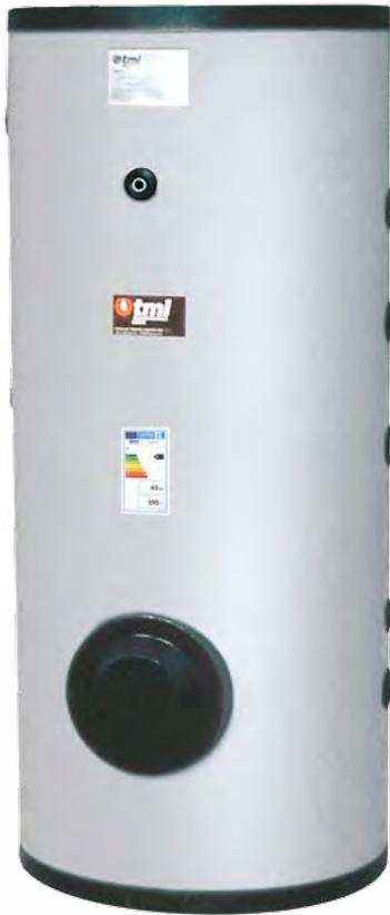
Accumulo termico per lo stoccaggio di Acqua Calda Sanitaria. L'accumulo, realizzato in acciaio al carbonio, protetto mediante trattamento interno vetroporcellanato/Keramtech, è dotato di un boccaporto d'ispezione che può essere utilizzato anche per l'inserimento di un riscaldatore elettrico.
