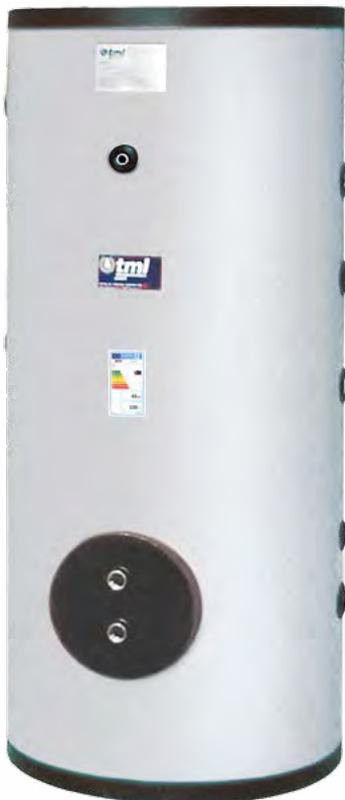
Bollitore per la produzione e lo stoccaggio di Acqua Calda Sanitaria. Il bollitore è realizzato in acciaio al carbonio protetto mediante trattamento interno vetroporcellanato/Keramtech. È dotato di scambiatore di calore estraibile a fascio tubiero in acciaio Inox AISI 316L idoneo ad essere alimentato con vapore. Lo scambiatore di calore è corredato di Dichiarazione di Conformità PED (ai sensi dell'Allegato VII della Direttiva Europea 97/23/CE).
