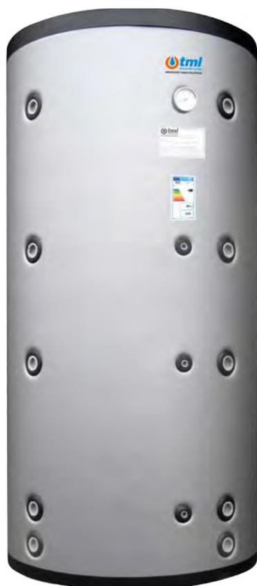
Termoaccumulo per lo stoccaggio di acqua da riscaldamento prodotta da sorgenti di calore continue e discontinue; produzione di Acqua Calda Sanitaria per mezzo di un accumulo interno in acciaio Inox AISI 316L (tank in tank).
