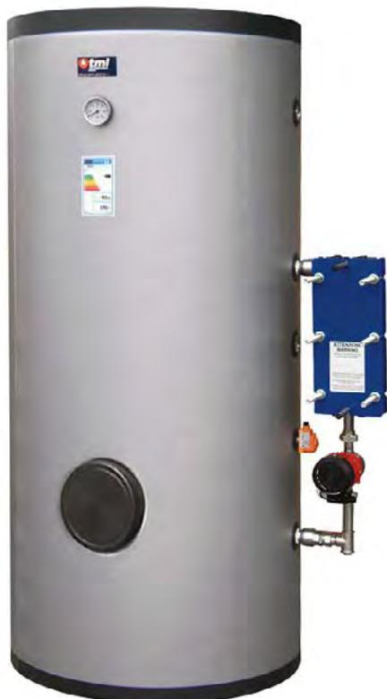
Preparatore rapido per la produzione e lo stoccaggio di Acqua Calda Sanitaria composto da un accumulo termico (disponibile nelle versioni vetroporcellanato o in acciaio Inox AISI 316L) e da un kit di scambio esterno. L'accumulo è dotato di boccaporto d'ispezione utilizzabile anche per l'inserimento di un riscaldatore elettrico o di uno scambiatore estraibile.
