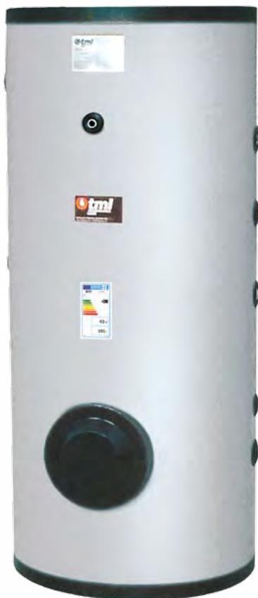
Accumulo termico in acciaio Inox AISI 316L per lo stoccaggio di Acqua Calda Sanitaria. L'accumulo è dotato di un boccaporto d'ispezione utilizzabile anche per l'eventuale inserimento di un riscaldatore elettrico.
